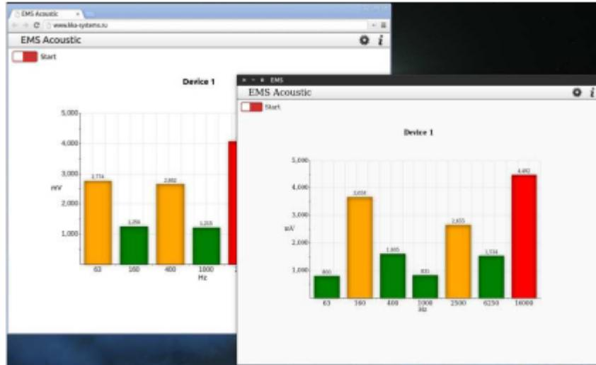
Рис. 3. Локальное (справа) и серверное (слева) приложения, запущенные на ОС Ubuntu 14.04, версии Qt.
